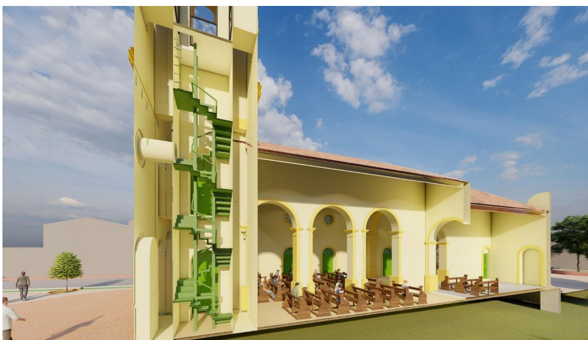
Figura 4: Corte da edificação apresentando a nova escada de acesso ao coro e campanário. Fonte: Architectus
